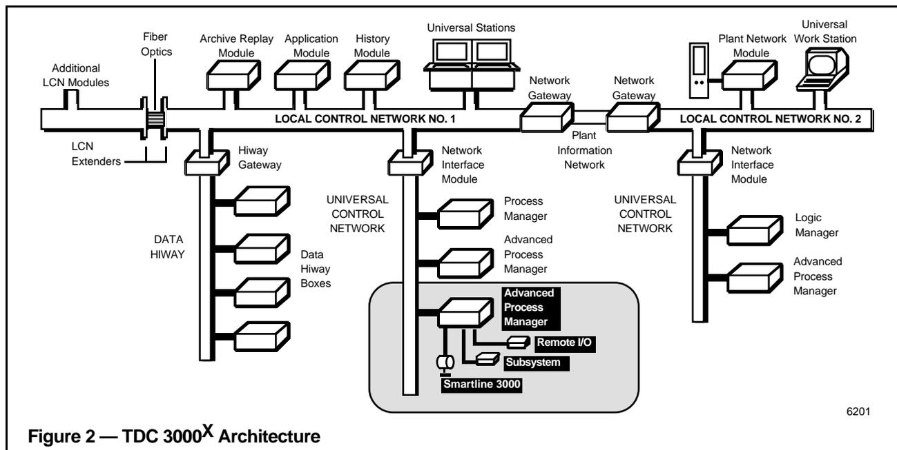
Figure 2 — TDC 3000<sup>X</sup> Architecture
